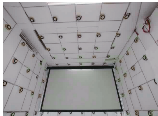
157 chの包囲型スピーカシステムを用いたアンビソニックス超高精細音空間映像再生システム Ultra high-definition audio and visual three-dimensional reproduction system using 157ch-loudspeaker array based on High-Order Ambisonics
