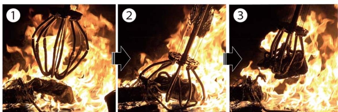
図11：耐火性グリッピング実験のロボットハンド部拡大図
