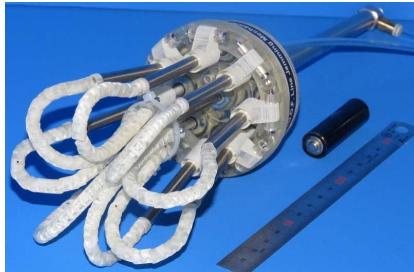
図7：1次元ジャミング機構を指としたロボットハンドの外観（簡易型汎用版）
