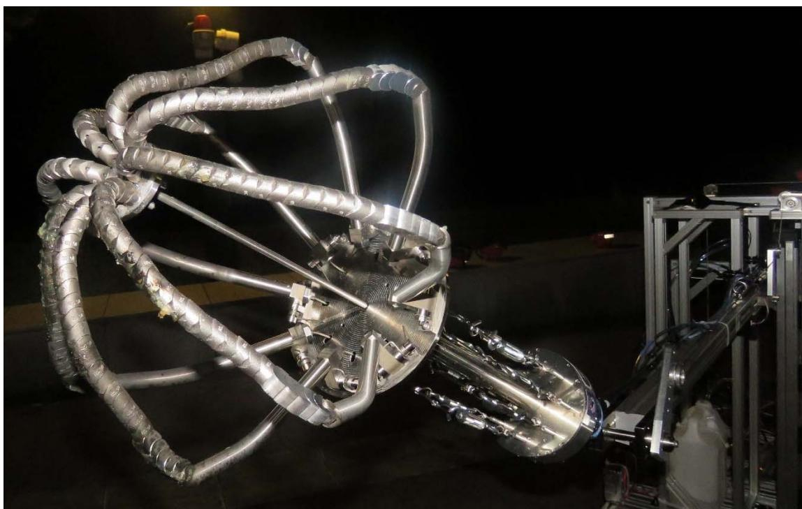
図3：耐火性を実現した数珠状ロボットハンド機構の外観
