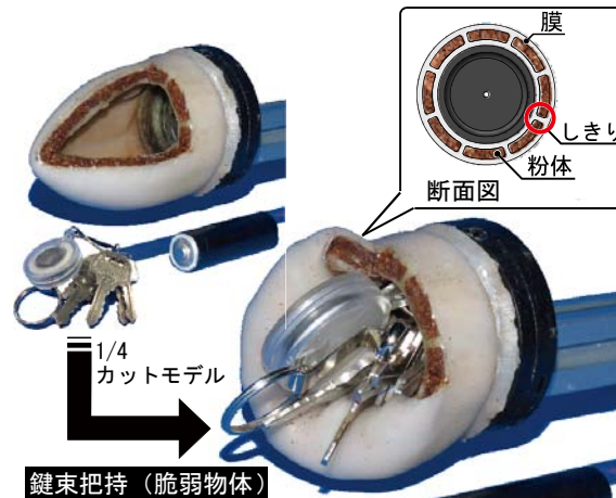
図3：ロボットハンドの構造
