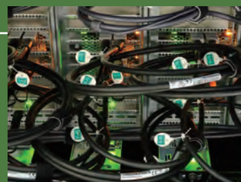
理研 佐野チームで開発中の回路再構成型並列計算機
