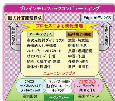
ブレインモルフィックコンピューティングハードウェアパラダイムの概要と、カオスニューラルネットワークリザーバーの基本的な構成
