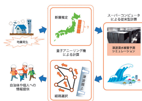
リアルタイム津波浸水予測・避難経路案内システム A real-time tsunami inundation simulation with routing assistance for evacuation
