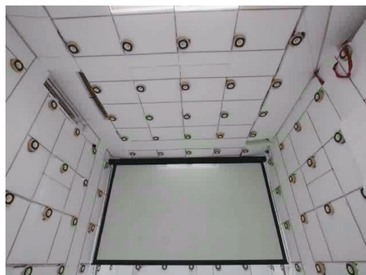
157 ch の包囲型スピーカシステムを用いたアンビソニックス超高精細音空間映像再生システム
