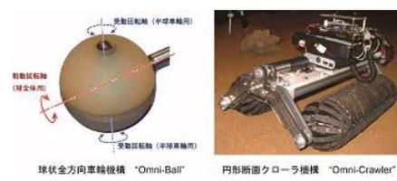
▲全方向移動メカニズムの例
